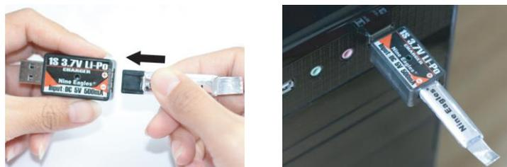
Der LiPo Akku kann auch mit dem USB Ladeadapter an einem USB Ausgang geladen werden. Verbinden Sie den LiPo Akku mit dem USB Ladeadapter. Stecken Sie nun den USB Ladeadapter an einem freien USB Ausgang an Ihrem PC Während des Ladevorgangs leuchtet die rote LED dauerhaft. Der Ladevorgang ist abgeschlossen, wenn die rote LED erlischt.
