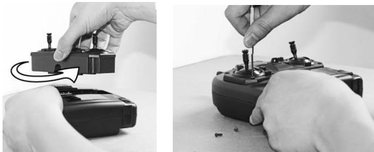
Bedienfeld um 180° drehen und wieder mit den Schrauben befestigen
